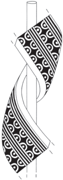
Abb. 4 Um einen Dorn gewundenes Schweißpaket aus vier verdrehten und nicht verdrehten Kompositstäben (Zeichnung: Altertumskommission für Westfalen/T. Maertens).
