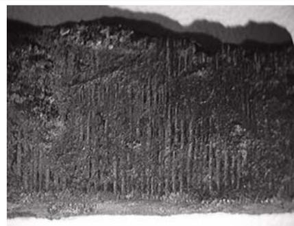
Abb. 8 Stereomikroskopaufnahme der römischen Messerfeile mit Spuren der Feilenhiebe.
